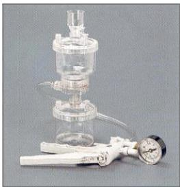
Práctico y económico equipo de filtración para membrana o filtro de 47 mm. de diámetro, formado por un embudo de 250 ml. y un frasco receptor de la misma capacidad, para realizar operaciones de filtración a baja presión. Todo ello fabricado en policarbonato y autoclavable a 121°C.
