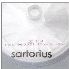
Unidades estériles de filtración por venteo de 62 mm. de diámetro con una membrana de teflón hidrófobo reforzada con una malla de polipropileno. Todo ello dentro de una carcasa de polipropileno. Son, por tanto ideales para trabajar con elevados volúmenes de aire y bajos diferenciales de presión.
