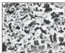
Una membrana muy apreciada por su buena estabilidad frente a muestras alcalinas o ácidas (pH: 3-12). Otra de sus características principales es su elevada adsorción no específica, lo cual le hace muy indicada para su uso, junto a papeles de cromatografía, en técnicas de transferencia de ácidos nucleicos.
