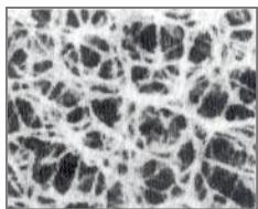
Una membrana químicamente muy resistente frente a muestras de disolventes orgánicos como acetona, acetonitrilo, etanol, etc. Es de naturaleza hidrofílica.
