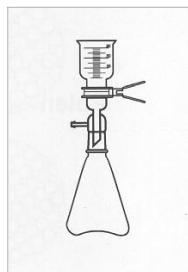
Tradicional equipo de filtración construido en vidrio 100%. Está formado por: Embudo de 300 ml., pinza de sujeción, cuerpo con placa porosa para filtros de 47 mm., y matraz kitasatos de 1000 ml. De capacidad.
