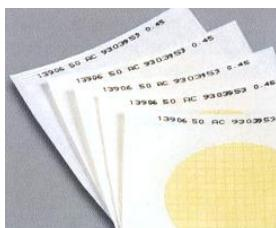
La nitrócelulosa es un material utilizado de manera habitual para la fabricación de filtros de membrana.
