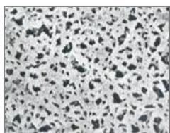
Un material muy fiable como filtro membrana por su excelente estabilidad química frente a soluciones acuosas con pH entre 4 y 8, la mayoría de los alcoholes, hidrocarburos y aceites.
