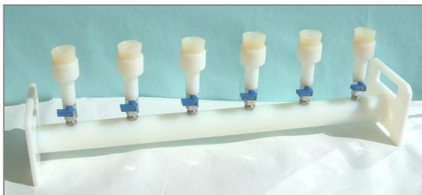
Constituyen una alternativa económica y muy fiable a las rampas de filtración de acero inoxidable. Están formadas por una estructura construida en nylon y cada puesto precisa la inserción de un tapón de silicona con orificio, donde se acoplan las piezas de vidrio correspondientes (base con placa porosa, embudo y pinza).
