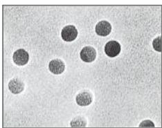
Las membranas de policarbonato se caracterizan por tener diámetros de poro muy precisos y de forma totalmente cilíndrica, buena estabilidad térmica ( hasta 140°C), y una baja adsorción no específica.
