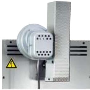
**Chimenea de salida con ventilador** para extraer mejor del horno los gases de escape que se originan. Con controlador P 320 conectable según programa.
