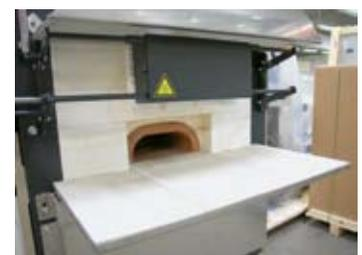
Superficie de trabajo delante de la mufra para la colocación de la carga
