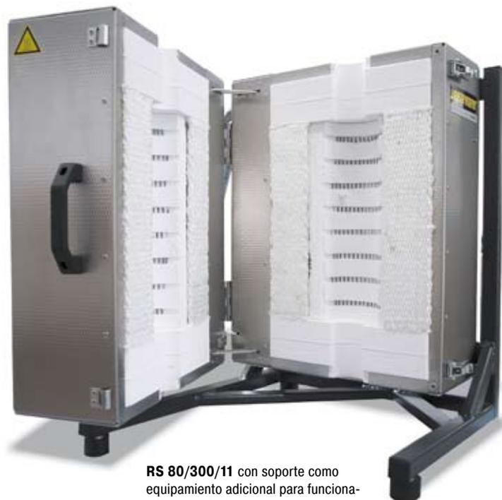
RS 80/300/11 con soporte como equipamiento adicional para funcionamiento vertical
