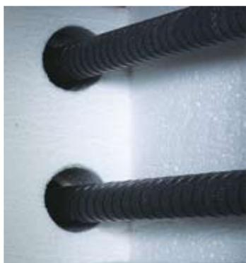
Cámara del horno de material de fibra de alta calidad un barras calentadoras de SiC en los laterales del horno
