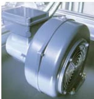
Ventilador de refrigeración conectado a una tapa automática para el aire de escape para acortar los tiempos de enfriamiento
