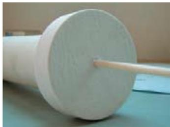
**Conjuntos de inyección de gas 1:** Tapones de fibra con conexión para gas de protección, adecuados para muchas aplicaciones en laboratorio
