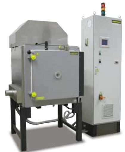
LH 120/12S con dispositivo de inyección de gas y apertura de carga en la puerta
