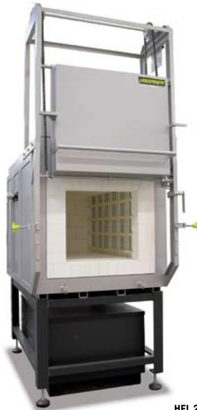
HFL 295/13 con puerta de elevación y transformador en versión sobre soporte, adaptado al cliente
