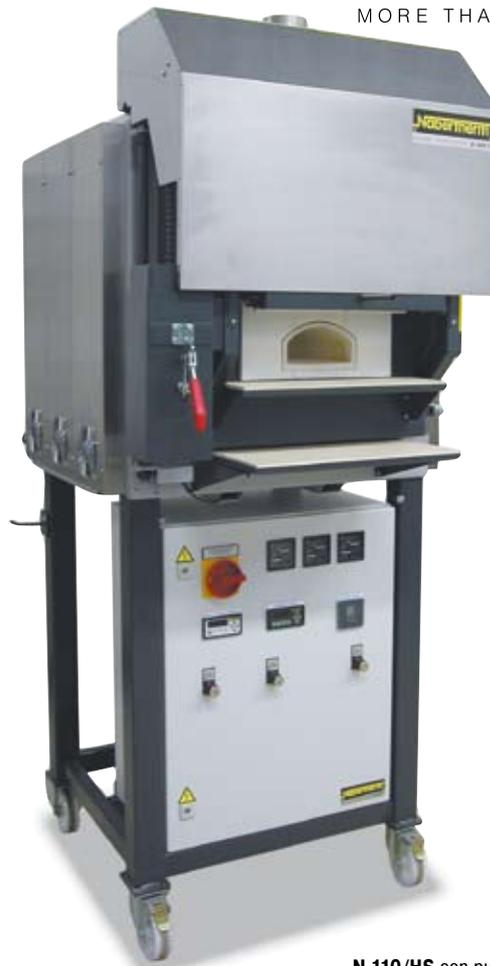
N 110/HS con puerta de elevación manual y unidad de conexión integrada
