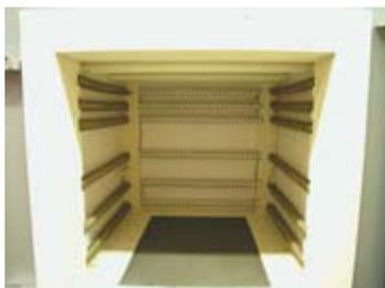
Interior de material de fibra con bajo mantenimiento del calor para un enfriamiento rápido en los modelos LF
