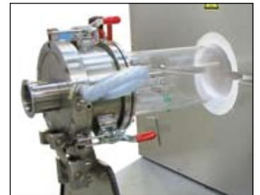
Vidrio cuarzo y brida para el funcionamiento con gas de protección como equipamiento opcional
