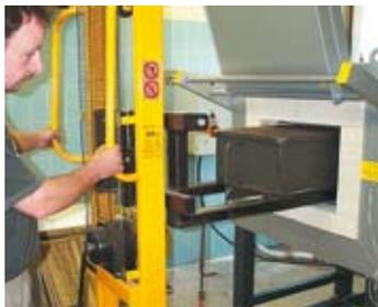
Trabajo con caja de inyección de gas para atmósferas de gas de protección con ayuda de un carro de carga
