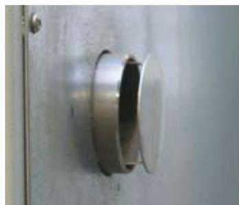
Apertura del aire de escape en la parte posterior para extraer los gases de escape que se originan durante el secado
