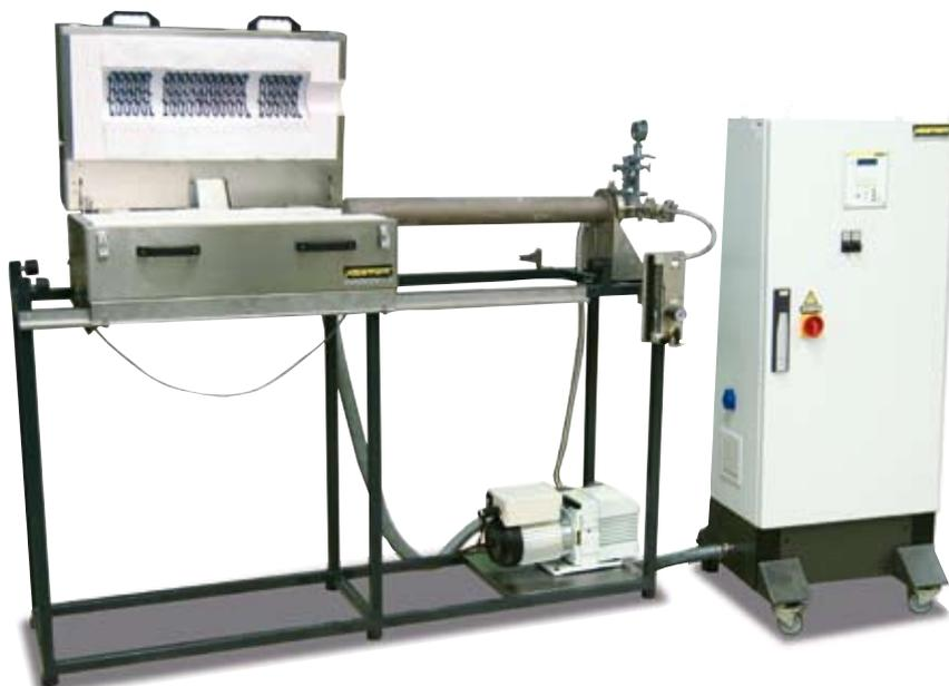
Unidad de regulación y conexión separada del horno
