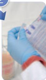
Insertar el soporte con las placas de Petri sembradas en la jarra. Abrir el sobre generador de anaerobiosis siguiendo las instrucciones del fabricante.
