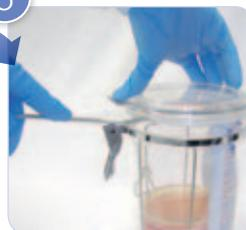
Ocasionalmente se puede generar vacío en la jarra después de la anaerobiosis, produciendo una presión negativa que impida la apertura de la jarra. Esto puede solucionarse utilizando un pequeño objeto para hacer palanca (como una espátula).
