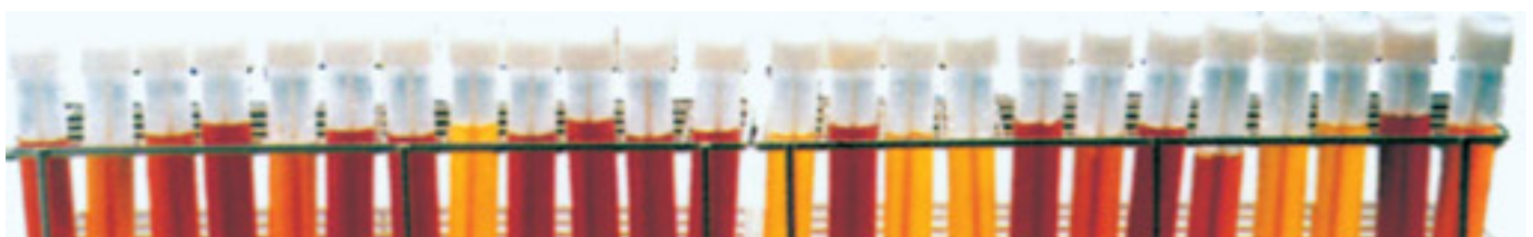
Abb. 12: Abstriche von Schwachstellen einer Abfülllinie
