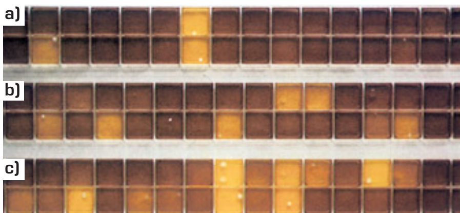
Abb. 8: Luftkeimindikatoren a) von Waschmaschine-Flaschenabgabe b) vom Füller c) vom Verschließer Befunde der Felder bei 5–20 % (a,b,c: Hygienezustand einwandfrei) d) Zahlreiche Kolonien mit L. brevis (Hygienezustand bedenklich)
