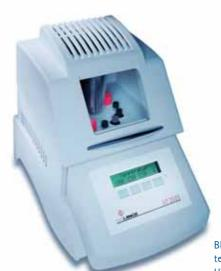
Bloque termostático de alta temperatura HT 200S
