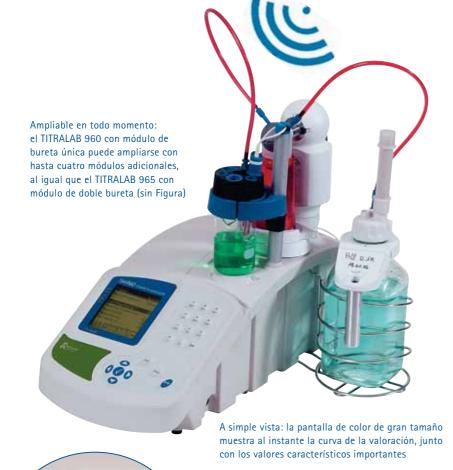
En sólo unos segundos se puede desmontar el soporte de buretas completo (con la bureta y los elementos conductores de valorante), acoplar a la botella de reactivo para ahorrar espacio y guardar en el estante
