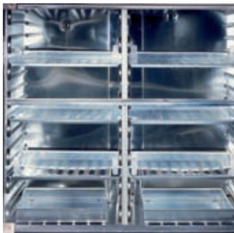
Especial Memmert: El interior, fabricado íntegramente en acero de primera calidad 1.4301 (ASTM 304) se presenta además con pulido electrolítico para reducir todavía más el riesgo de contaminación.
