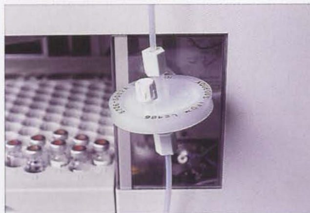
Filtros en línea
