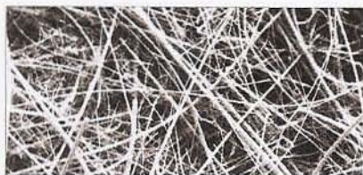
Los filtros Whatman de fibras de vidrio se fabrican de microfibras de vidrio de borosilicato 100%.
