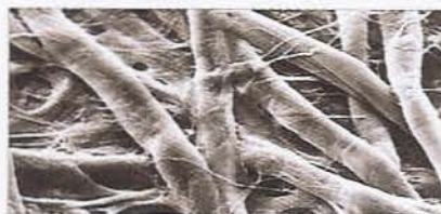
Los filtros Whatman de papel de celulosa retienen partículas hasta por debajo de 2,5 µm.
