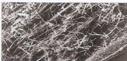
El filtro Multigrade GMF 150 combina dos filtros en uno y permite una filtración rápida y efectiva.
