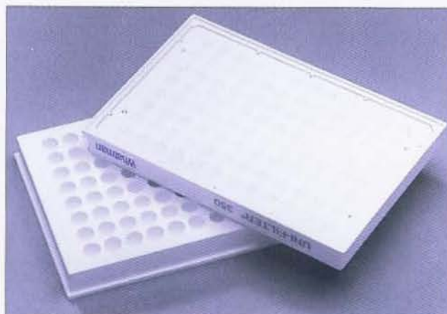
Microplaca UNIFILTER de 96 pocillos: fondo con malla
