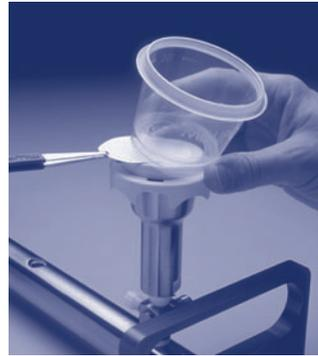
3. Después de la filtración, levantar el embudo — sólo necesita una mano — y descártelo. (Es reciclable).
