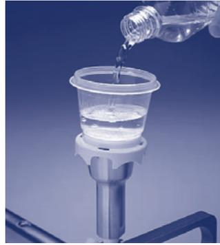
2. Colocar la unidad sobre el tapón estándar n° 8, verter la muestra y aplicar vacío.
