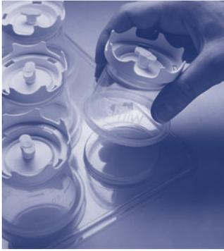
1. Colocar la bandeja cerca de la rampa de filtración o del matraz de vacío y extraer la unidad.
