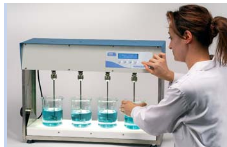
Floculador "Flocumatic" con elementos de iluminación en posición vertical. 6 plazas.
