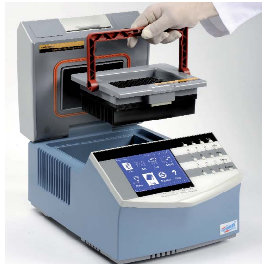
Termociclador puerta abierta con sistema calefactor en la contrapuerta para evitar condensaciones.
