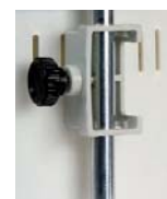
Dispositivo que permite sujetar la varilla soporte de 12 mm de Ø.
