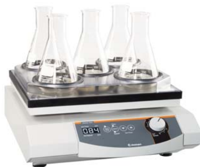
Unimax 1010 con adaptador para 5 Erlenmeyers como accesorio.
