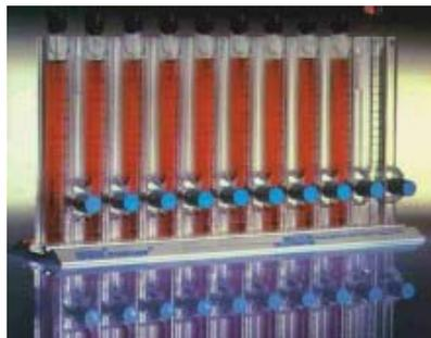
**SEDITAINER 1.8 (SEDISYSTEM TUBE):** Tubo para ERS, en vidrio resistente con buffer citrato 0.105 M equivalente a una concentración de citrato de sodio al 3.2 %, con un volumen aproximado de aspiración de 1.8 ml, de 8 mm de diámetro externo x 6 mm de diámetro interno x 100 mm de longitud y tapón siliconado hemorrepeleante. *(Cat. 366676)*
