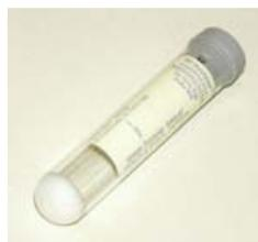
**Tubo con preservante**, en vidrio, contiene un estabilizador liofilizado que detiene la proliferación de bacterias por 24 hs. a temperatura ambiente, evita cambios de pH y la falsa formación de cristales. Volumen aproximado de aspiración de 5.0 ml, de 16 x 75 mm y tapón convencional *(Cat. 364976)*
